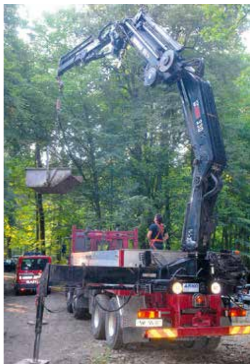
Dvigovanje odpadkov iz vhodnega brezna s pomočjo hiab dvigala, vitla in škripca. Foto TOMAZ BUKOVEC
