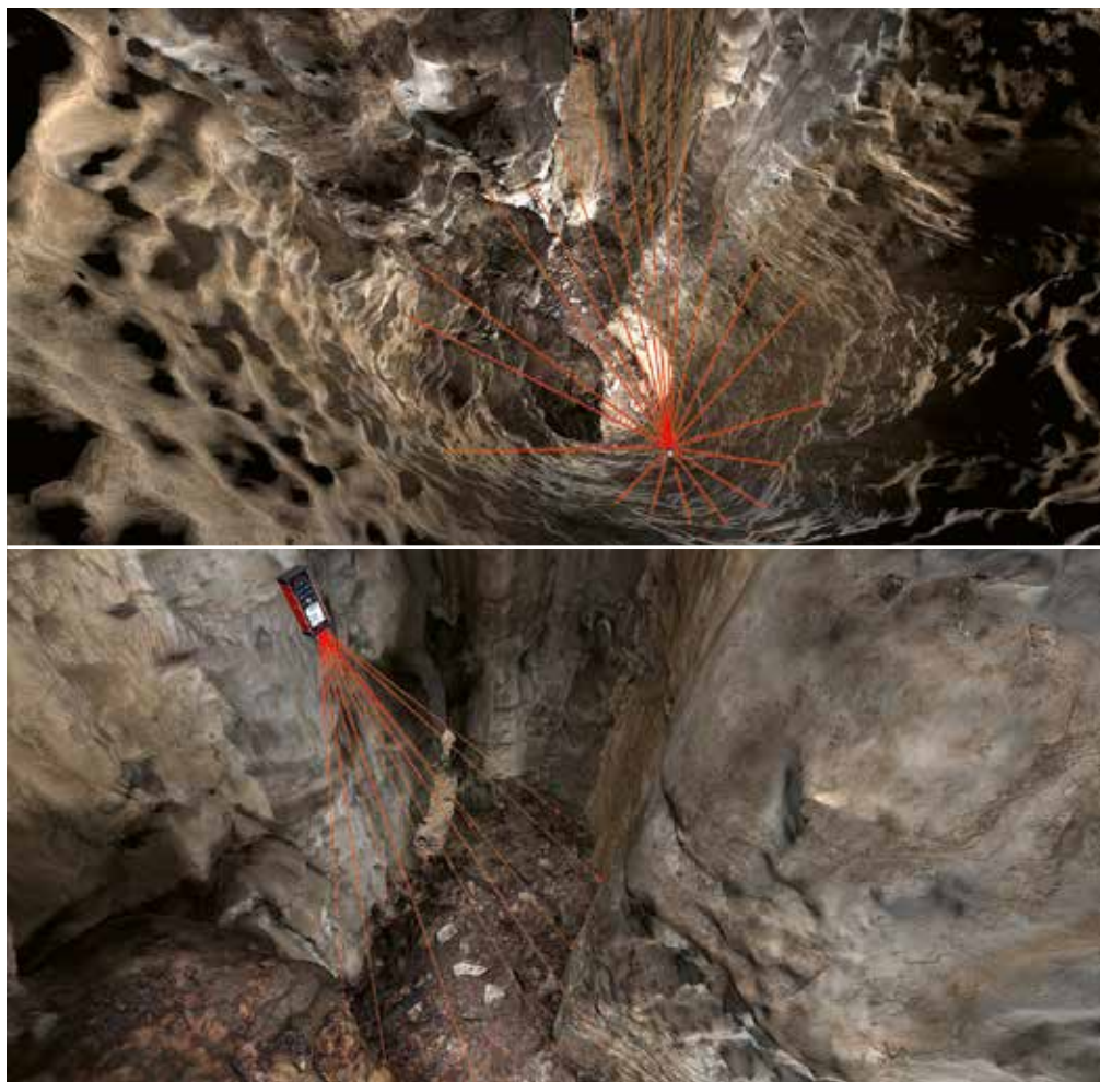
Skeniranje oblike tal (zgoraj) in skeniranje profila.
