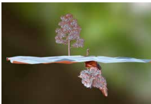
Cvinger. Kombinacija foto skena in skena z DistoX2.
